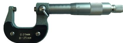
Elle se déplace le long d'une douille graduée au pas de la vis.
