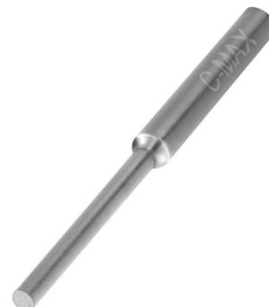
Les ébauches étagées en carbure C-Max a un diamètre de broche de 2,35 mm et est disponible en diamètre de 0,8 à 2,2 mm, par pas de 0,2 mm.
